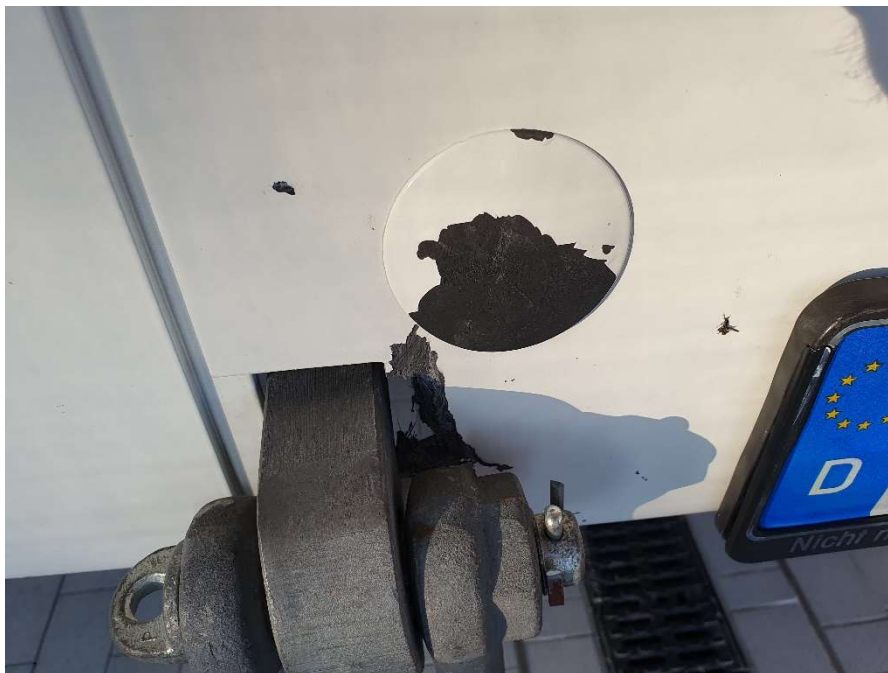
Bild 4: Korrosion und Lackschäden
