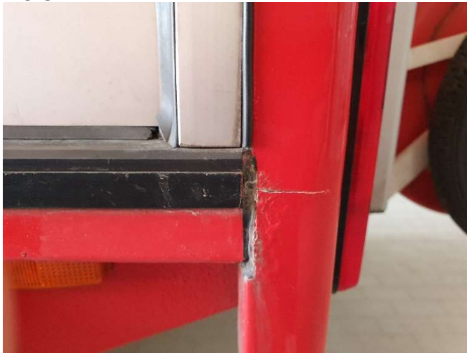
Bild 2: Korrosion an Befestigung der Rückwand; waagerechter Riss an der Rückwand
