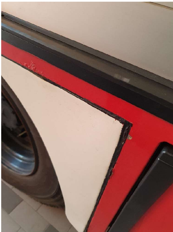
Bild 3: Korrosion am Fahrzeugaufbau; auflösende Dichtnaht (Sikaflex o.ä.)
